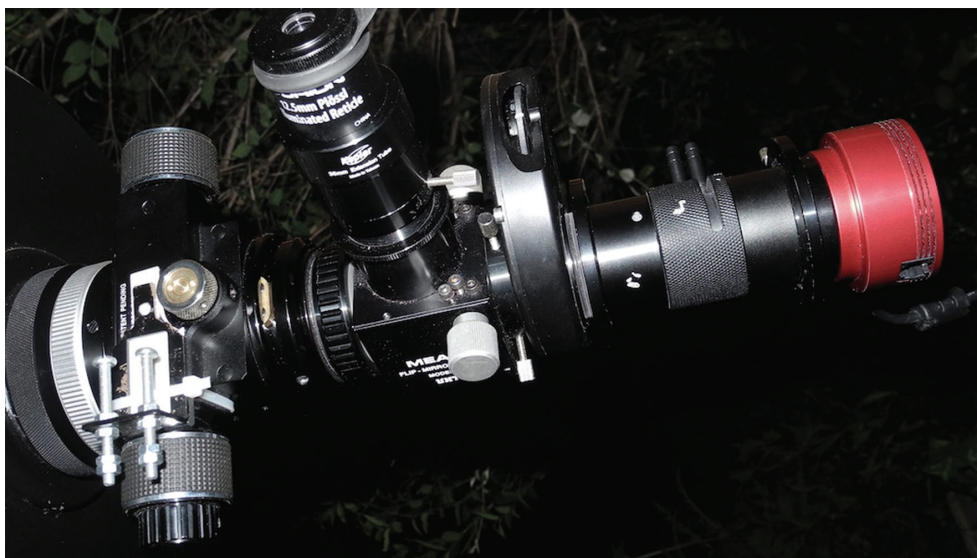
Figure 3 – Train optique utilisé par l'auteur derrière un Celestron C11 ( E=0,093 arcsec/pixel)
